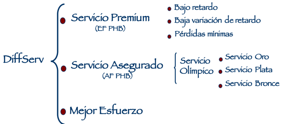
Figura 13. Diagrama de implementación para Servicios Diferenciados.
