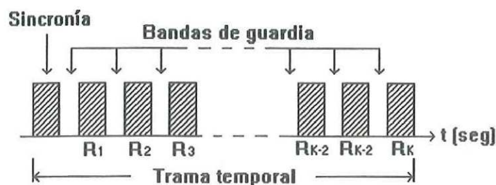
Figura 6. Diagrama de ranuras de tiempo (canales) en el esquema TDMA.
