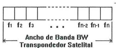
Figura 1. Asignación de bandas de frecuencia en un esquema FDMA.
