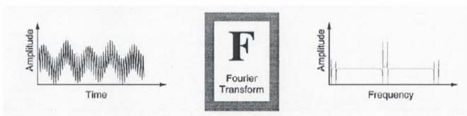
Figura 2. Diagrama esquemático de la Transformada de Fourier en una señal
