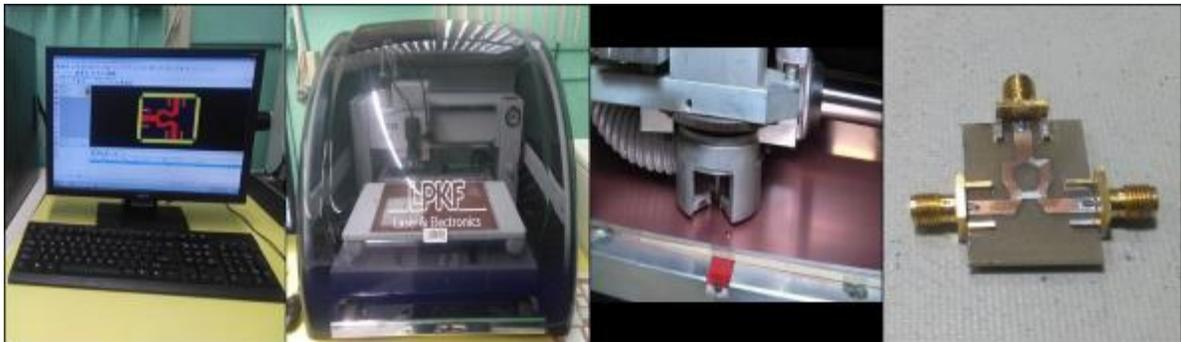
Figura 66. Proceso de fabricación en maquina LPKF S103.
