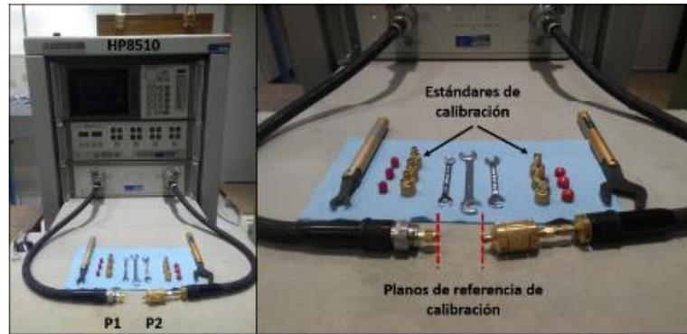
**Figura 68.** Medición de parámetros S en el analizador de redes HP8510.
