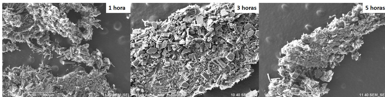
**Figura 52.** Micrografías de SEM de CNx dispersos a diferentes tiempos.
