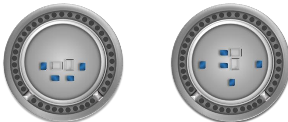
Figura 17. Distribución de muestras en el reactor. Los sustratos de sílice se muestran transparentes y los testigos de silicio azules.
