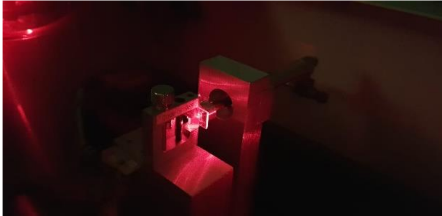
Figura 31. Láser de 633 nm incidiendo en una guía de onda de \text{Al}_2\text{O}_3 , acoplamiento por prisma.
