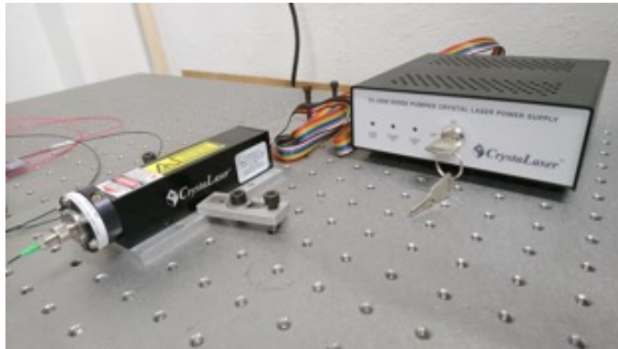
Figura 20. Láser de Nd:YAG de 1064\text{ nm} con su fuente de alimentación
