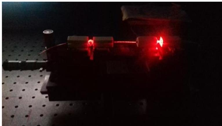
**Figura 32.** Alineación de la muestra de ambas monturas con haz láser de 632 nm (rojo).
