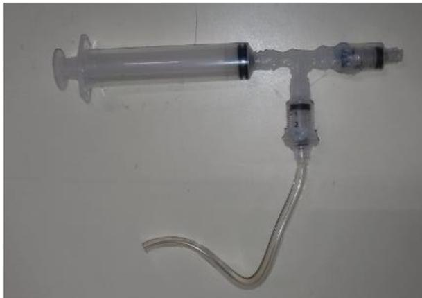
**Figura 23.** Bomba de vacío casera.
