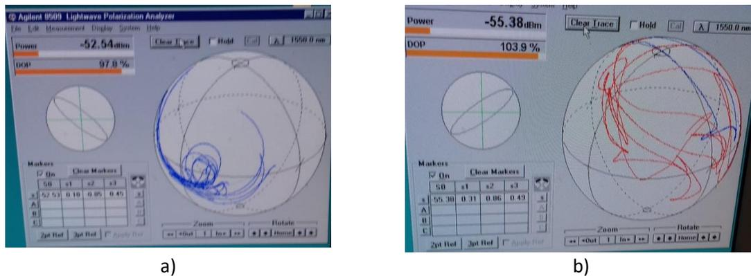
**Figura 46** Resultados del SOP de salida obtenidos usando el arreglo de la Figura 44 para la fibra de núcleo líquido infiltrada con licor de café. A pesar de que el ángulo azimutal del SOP de entrada se mantuvo fijo, se obtuvieron trazas que muestran una evolución caótica del estado de polarización.
