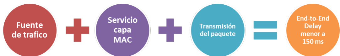
Figura 31. Factores que intervienen en el cálculo del end-to-end delay .
