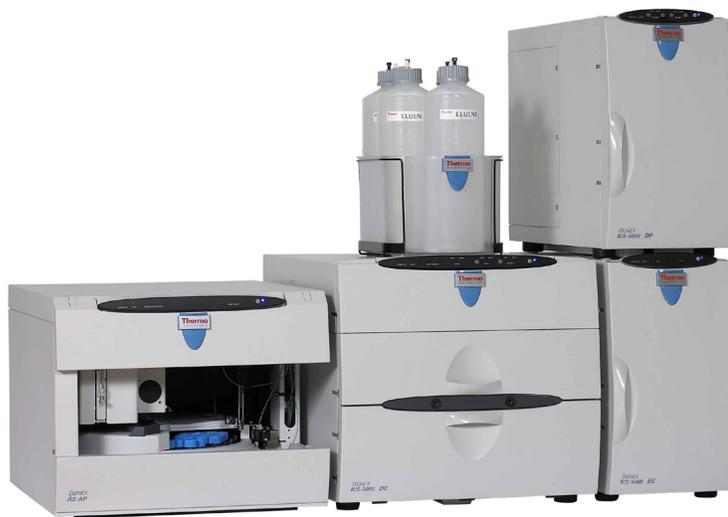
**Figura 17.** Equipo marca Dionex / Thermo Scientific modelo ICS-5000. © Dionex / Thermo Scientific.
