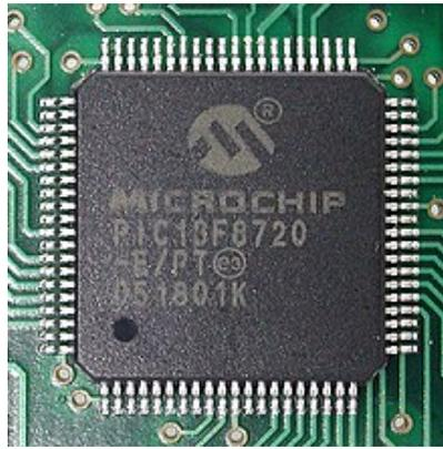
**Figura 24.** Microcontrolador de montaje superficial de la compañía Microchip.
