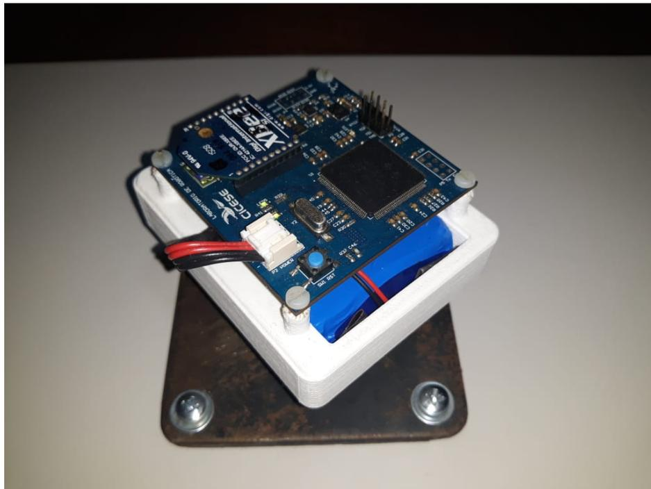
**Figura 52.** Tarjeta MMAVA montada en la maqueta de pruebas.
