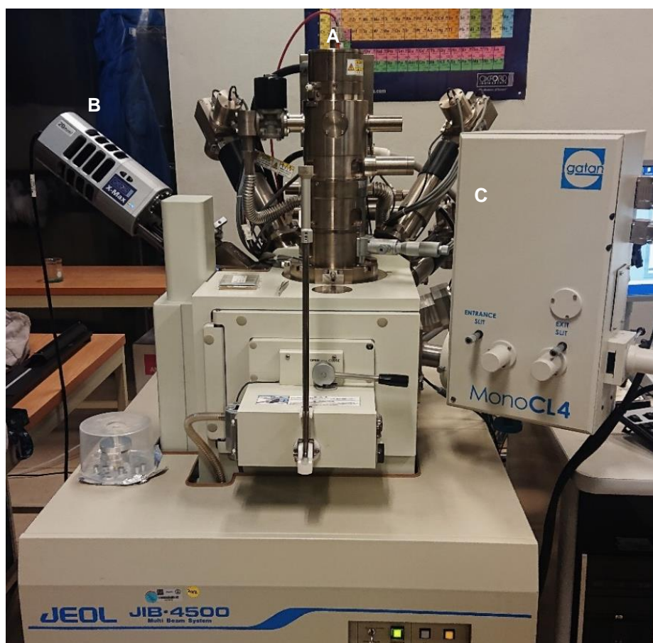
Figura 19. Sistema integral de microscopía electrónica JEOL JIB-4500. A) Columna del cañón de electrones, B) Detector de rayos X y C) Monocromador CL.
