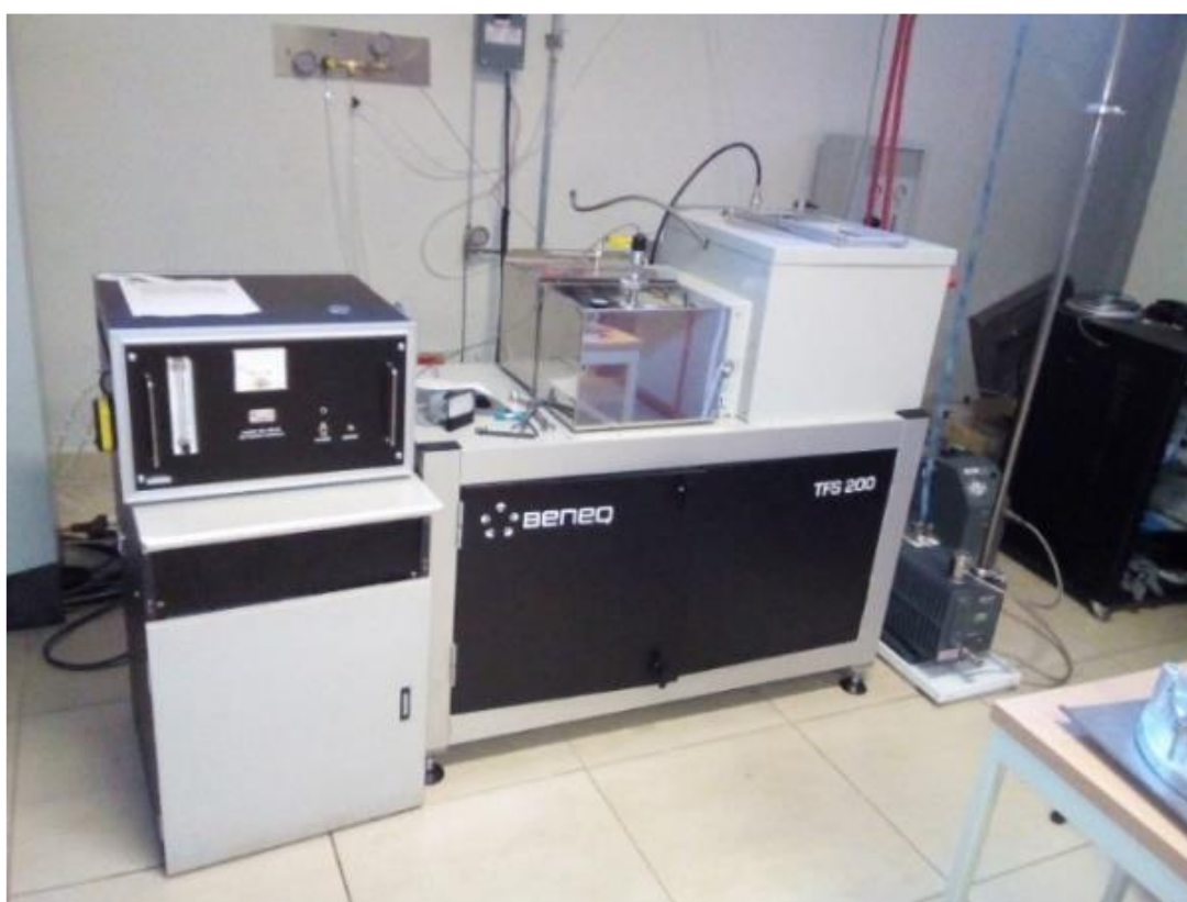
Figura 7. Equipo Beneq TFS 200 utilizado para la síntesis de ZnO en este trabajo y un diagrama representativo.
