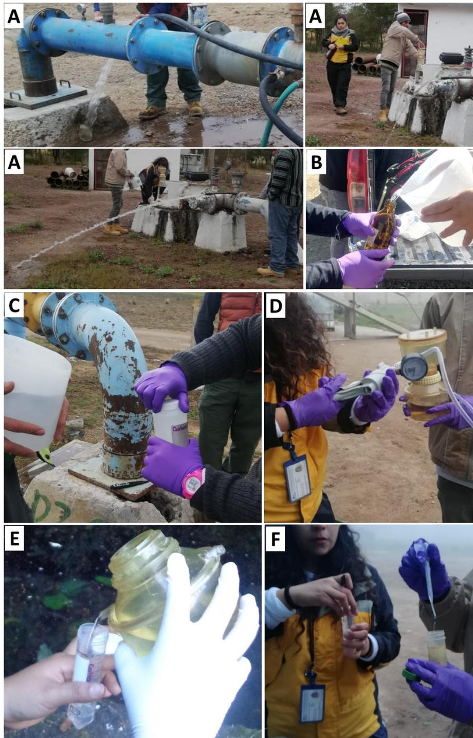
**Figura 10.** Colección y preservación de muestras: A) Purgado de tuberías de los pozos de agua subterránea. B) Almacenamiento de muestra sin filtrar, para la determinación de compuestos orgánicos. C) Almacenamiento de muestra sin filtrar, para la determinación de alcalinidad. D) Filtrado de muestra. E) Almacenamiento de muestra filtrada (procedimiento para la determinación de aniones y cationes). F) Acidificación de la muestra filtrada (cationes).
