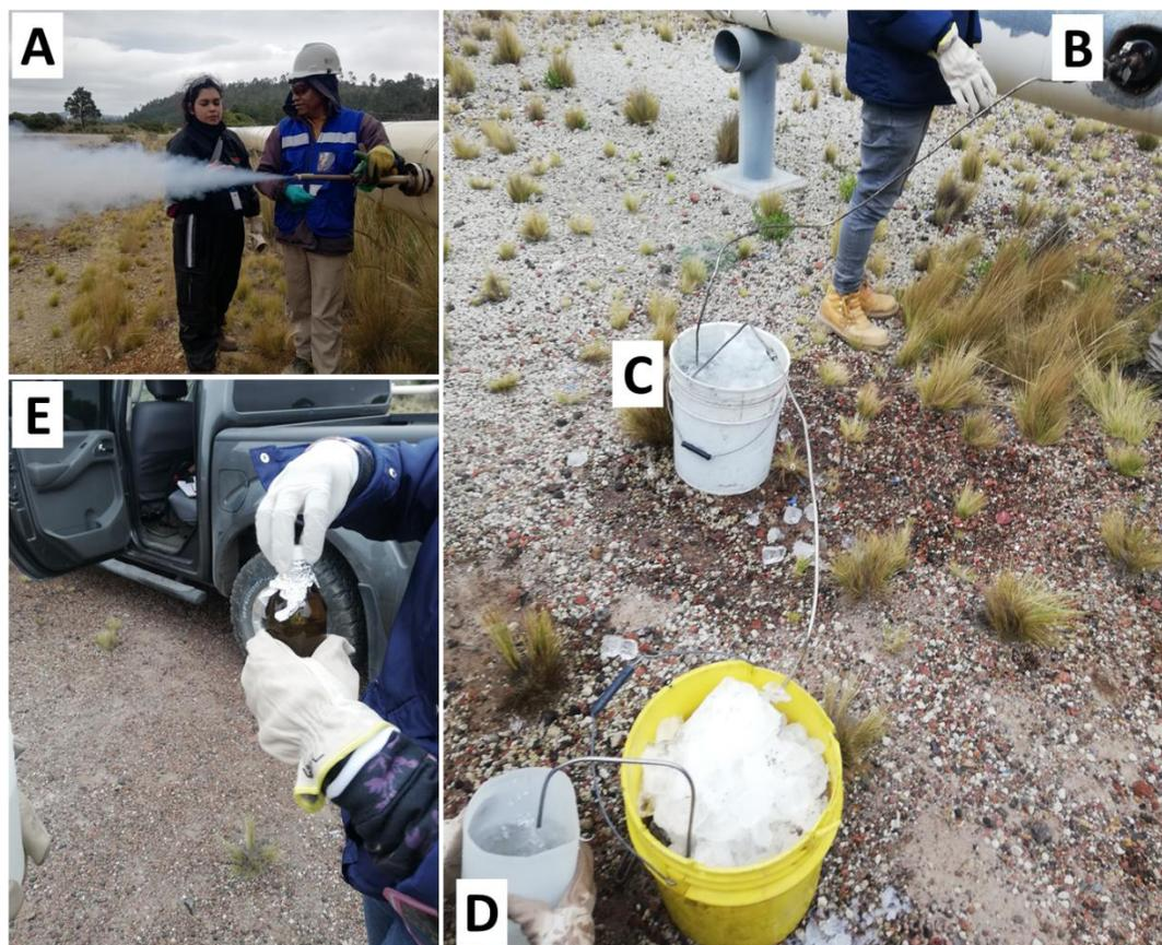
**Figura 12.** Configuración para el enfriamiento de vapor y el muestreo de condensado de vapor. Los números en la figura corresponden al método descrito anteriormente: A) Purgado de tubería. B) Conexión entre la válvula de tubería de vapor y el doble serpentín de enfriamiento. C) Enfriamiento y condensado de vapor, utilizando recipientes con suficiente hielo. D) Recolección de condensado de vapor. E) Almacenamiento de muestra para determinación de compuestos orgánicos.
