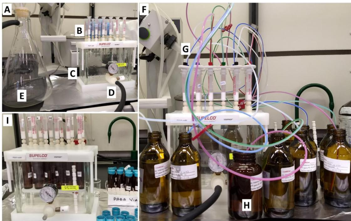
**Figura 16.** Materiales y procedimiento para la Extracción en Fase Sólida: A) Acondicionamiento de cartuchos de SPE C<sub>18</sub>. B) Cartuchos para SPE C<sub>18</sub>. C) Colector de vacío para cartuchos SPE. D) Válvula de conexión a bomba de vacío. E) Matraz de succión de desechos. F) Introducción de la muestra a los cartuchos para SPE C<sub>18</sub>. G) Tubos de transferencia de muestra adaptados a cartuchos de SPE. H) Muestras. I) Desorción de muestras purificadas y concentradas.
