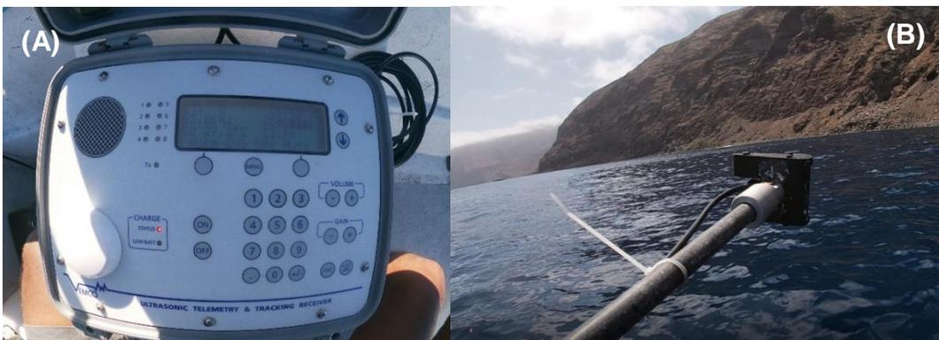
**Figura 4.** A) Receptor VR100. B) Hidrófono uni-direccional fijado a una barra de acero galvanizado.
