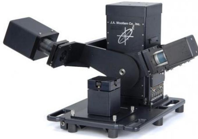
**Figura 20.** Equipo de Elipsometria J. Woollam M-2000.
