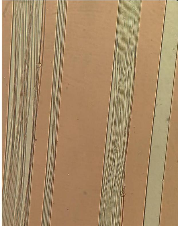
**Figura 35.** Imagen de familias grabadas con el objetivo 100x NA 0.9 con una velocidad de 1 mm/s a distintas separaciones entre líneas, se excedió el tiempo de revelado por lo que el químico tiende a entrar incluso debajo la resina hasta eliminarla.
