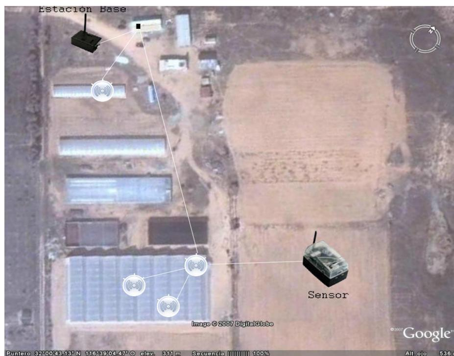
Figura 3: **Instalación de una red de sensores en un invernadero Ambar 960**
