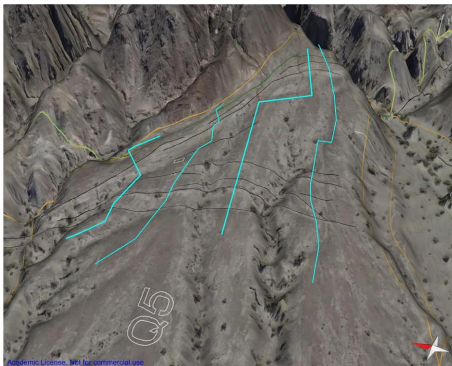
**Figura 25.** Imagen 3D de segmento de la faja interna de la falla CDD. Las líneas azules definen la traza de los perfiles topográficos, las cuales se encuentran sobre superficies de los abanicos aluviales menos erosionadas, lo que permite que, en medida de lo posible, que las mediciones estén libres de errores por erosión o debido a que los marcadores superficiales (ver texto para mayor explicación) sean definidos sobre canales.
