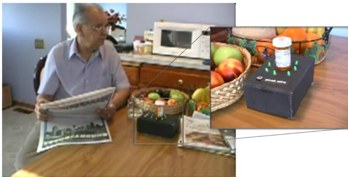
Figura 12. Ejemplo de un dispositivo visual y auditivo que notifica a la persona sobre la medicación correspondiente 5 .
