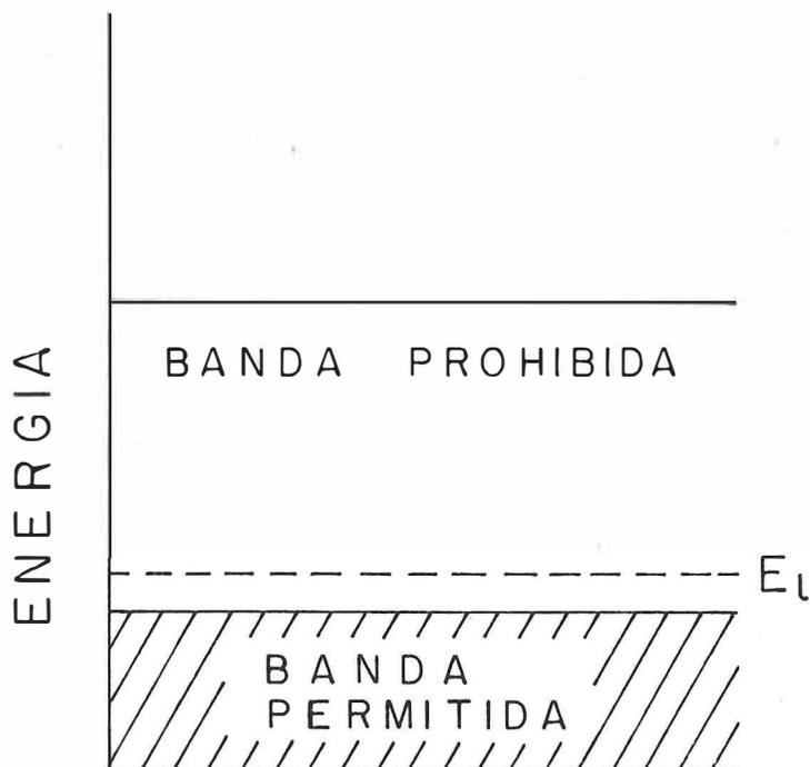
Figura 6. Bandas de energía para un cristal con defecto en su estructura periódica.
