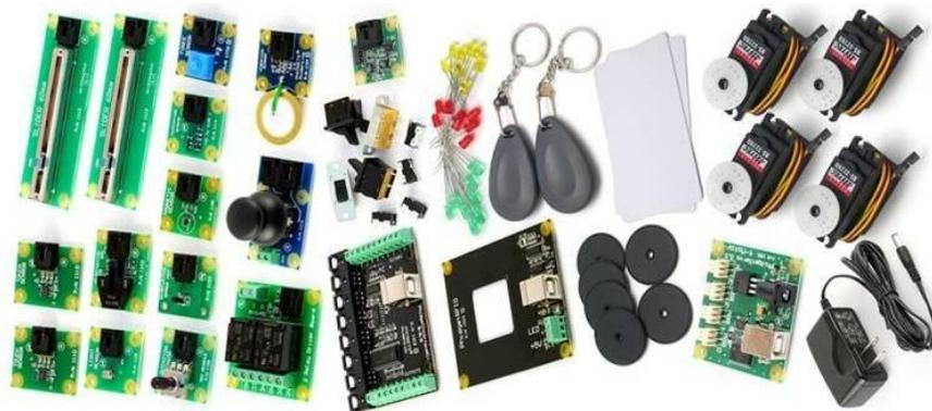
**Figura 8.** Conjunto de phidgets, servo motores, lectores RFID, botones, etc.
