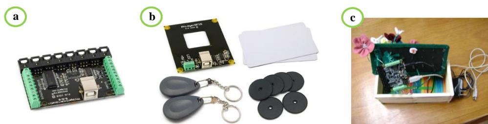
**Figura 23.** Phidgets. a) InterfazKit 8/8/8. b) RFID. c) Los dispositivos en el FlowerBlink.
