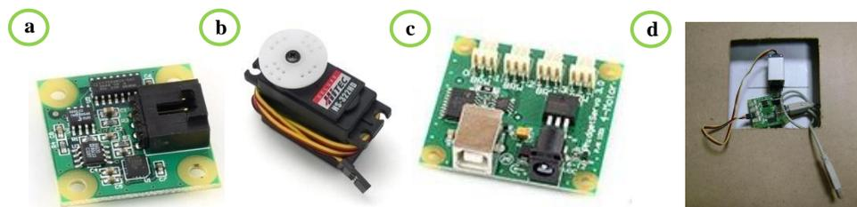
**Figura 29.** Phidgets. a) Acelerómetro. b) ServoMotor. c) 4-MotorControl. d) Los dispositivos en el MotionStatue.
