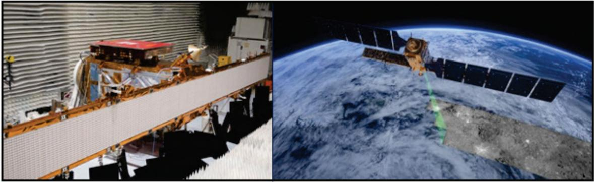
**Figura 14.** Izquierda- Antena SAR del satélite Sentinel 1A. Derecha- Ilustración artística del satélite Sentinel 1 haciendo un barrido de radar con vista lateral derecha sobre la superficie de la Tierra. Imágenes tomadas de ESA (2019).
