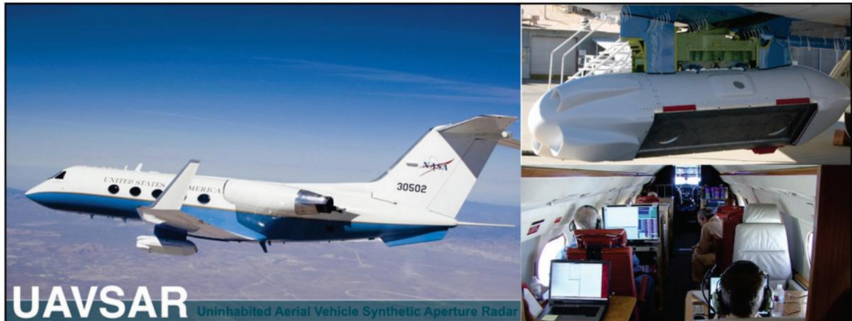
**Figura 15.** Vehículo Aéreo No-tripulado de Radar de Apertura Sintética (UAVSAR). Derecha superior- Se observa el sensor SAR que porta el avión, orientado con vista lateral izquierda. Derecha inferior- Tripulación que se encarga de operar una ruta de vuelo pre-programada. Imágenes tomadas de JPL (2019).
