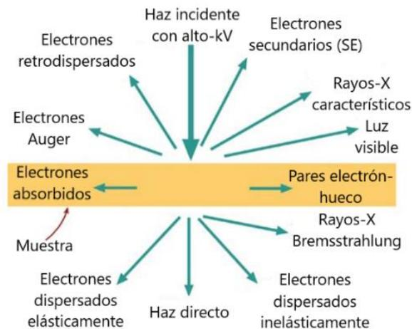
**Figura 3.** Diagrama de señales secundarias producidas en el Microscopio electrónico de Transmisión. (Tomada y modificada de Williams & Carter, 2009)
