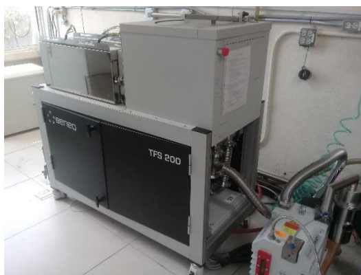
Figura 13. Equipo BENEQ TFS 200 para el depósito de películas delgadas por ALD.
