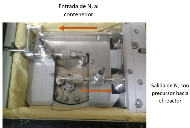
Figura 47. Contenedor instalado en una fuente caliente del equipo BENEQ TFS 200. Las flechas naranjas indican la dirección del gas de arrastre.
