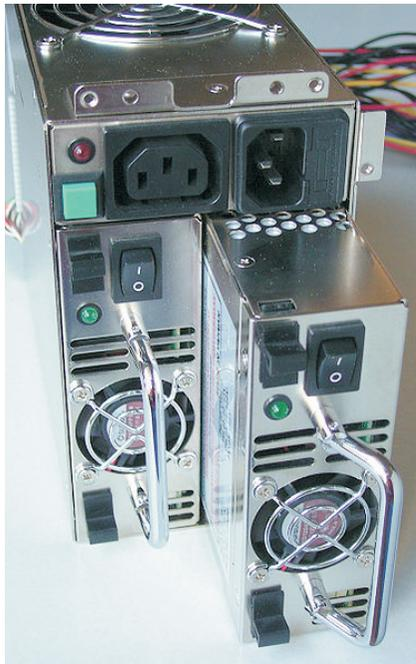
Figura 8. Fuente de poder redundante.
