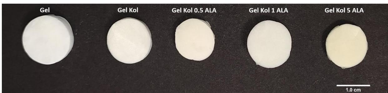
**Figura 9. Fotografía de los hidrogeles implantables.** Se sintetizó un hidrogel “blanco” a base de sólo polímero, gelatina 0.75% (Gel). Como otro control, se sintetizó un hidrogel con Kolliphor:Etanol 0.125:1 (Kol). Se sintetizaron 3 formulaciones de hidrogeles con ácido  $\alpha$ -lipoico, 0.5 mM (0.5 ALA), 1 mM (1 ALA), y 5 mM (5 ALA).
