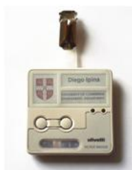
Figura 3. Active Badge . Las señales infrarrojas emitidas por el Active Badge permitían determinar la ubicación del usuario a nivel de habitación.
