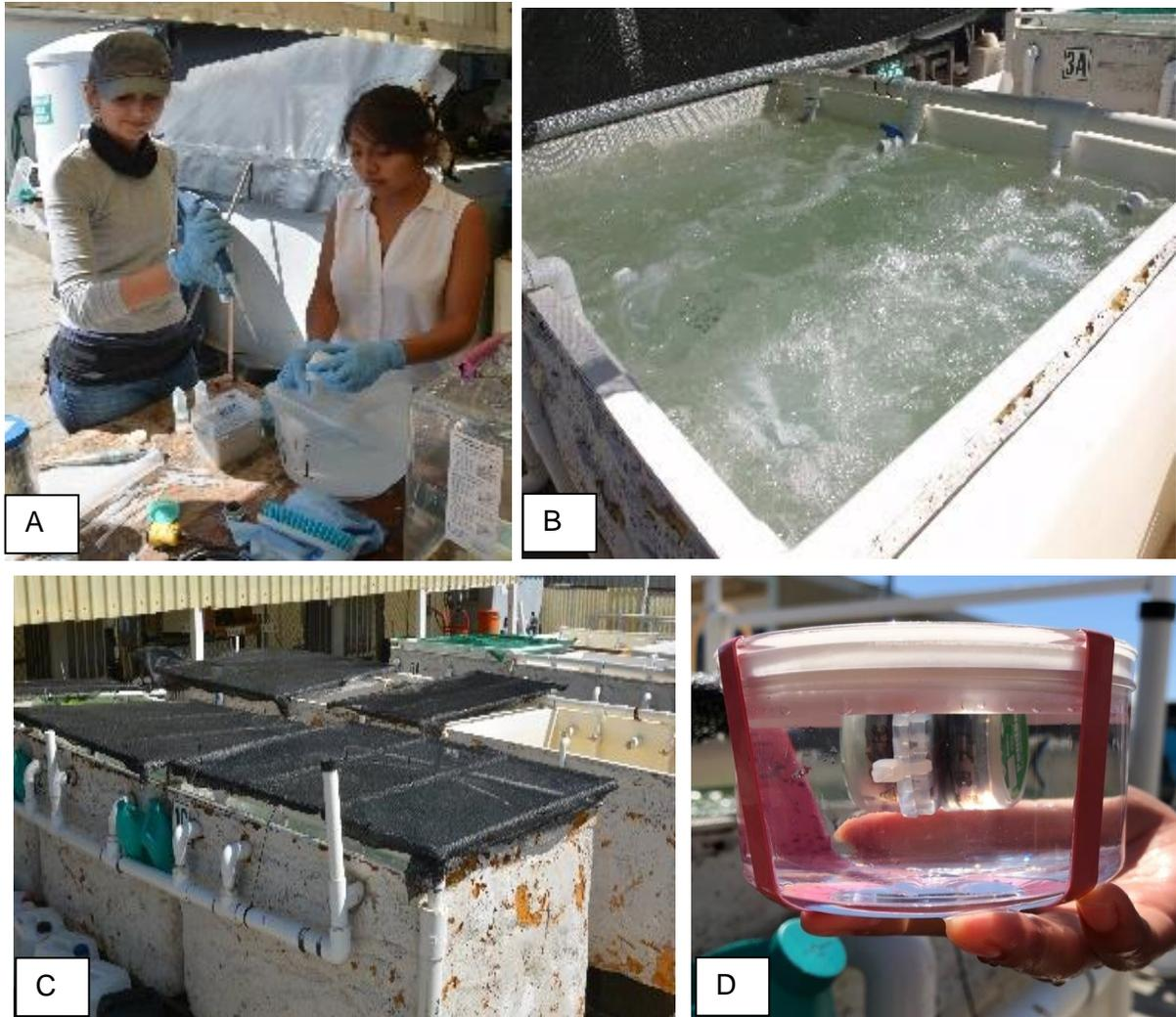
**Figura 6.** Implementación de experimento de mesocosmos. A) Preparación de botellas con nutrientes inorgánicos. B) Sistema de circulación de tanques de incubación. C) Tanques de incubación con malla. D) Sensores de temperatura e irradiancia.
