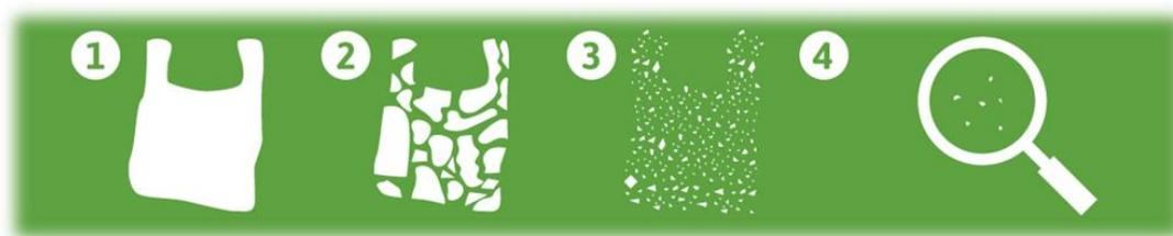
**Figura 2.** Degradación de plástico. 1) Objeto plástico completo. 2) Comienza la pérdida de integridad física del objeto. 3) Las partículas que formaban el objeto ya no se encuentran integradas. 4) Es posible apreciar partículas microscópicas.
