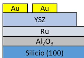
**Figura 26.** Esquema representativo de la batería Au-YSZ-Ru.
