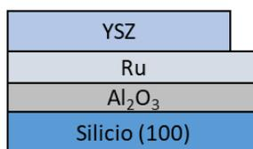
**Figura 24.** Esquema representativo del depósito ALD de YSZ sobre el electrodo inferior de rutenio.
