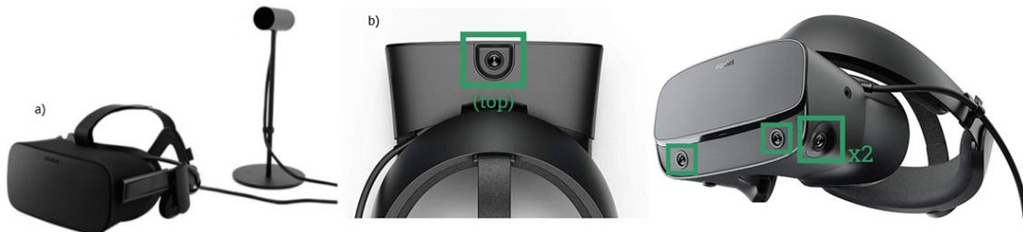
**Figura 3.** a) Casco Oculus Rift con una cámara externa que necesita ser posicionada en un punto fijo de la habitación. b) Casco Oculus Rift S con cinco cámaras integradas. En ambos casos las cámaras cumplen la misma función, corregir el error de deriva generado por los sensores propioceptivos utilizados para rastrear la posición del usuario (Borrego *et al.*, 2018) (Oculus, 2019).
