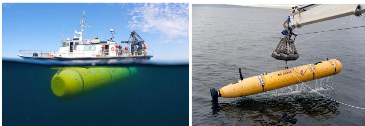
**Figura 3.** Vehículo submarino autónomo (AUV) de MBARI en superficie. Imagen tomada de [www.mbari.com](http://www.mbari.com)
