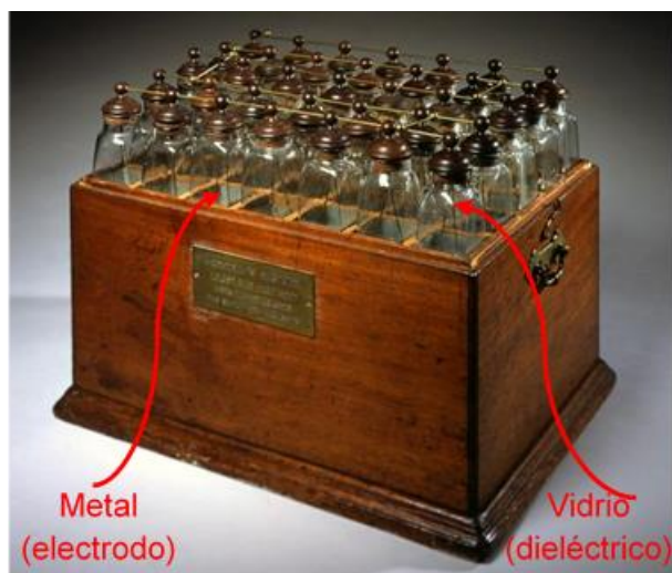
Figura 3. Gran capacitor construido por Benjamín Franklin. Compuesto de 35 botellas de Leyden. Fotografía por American Philosophical Society Copyright (2018), https://spectrum.ieee.org/tech-history/dawn-of-electronics/ben-franklins-iotheri-great-electrical-discovery-turkey-tenderization .
