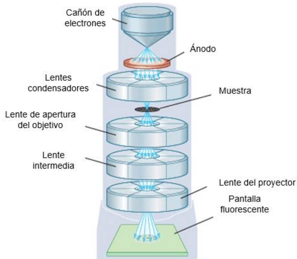
Figura 20. Diagrama básico de un microscopio electrónico de transmisión. Tomada y adaptada de la referencia (Bradbury et al., 2019).
