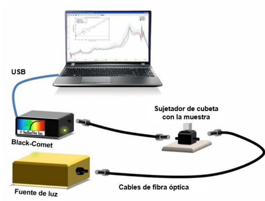
Figura 18. Diagrama de configuración del espectrómetro UV-VIS-IR StellarNet.
