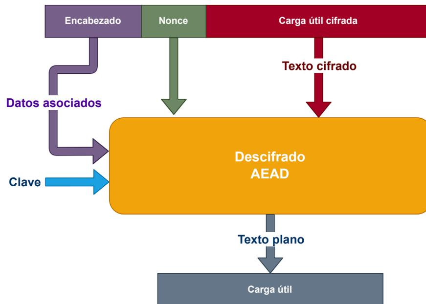
**Figura 20.** Entradas y salidas de la operación de descifrado de un esquema cifrado autenticado por datos asociados.
