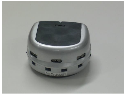
Figura 16. Robot Khepera III. Imagen tomada de (Schidt et al. , 2015).
