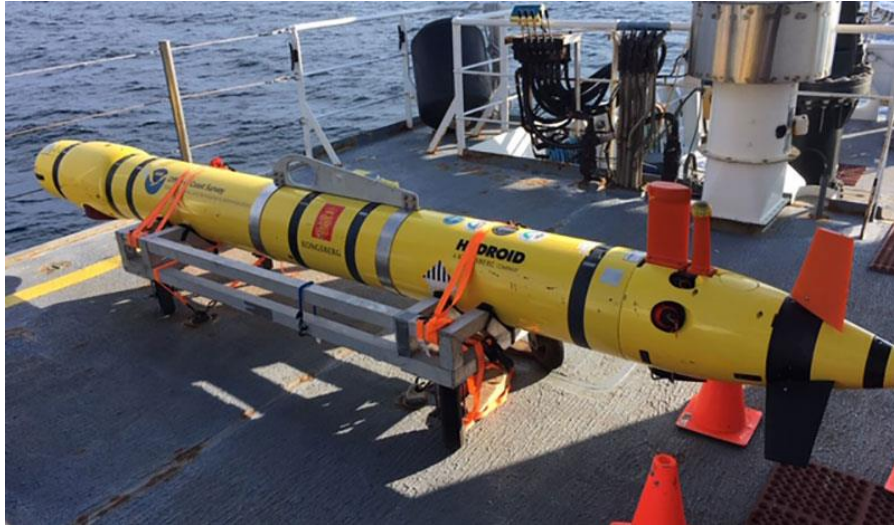
Figura 5. Vehículo autónomo submarino REMUS 600. Imagen tomada por la Oficina Nacional de Administración Oceánica y Atmosférica (NOAA, 2016).
