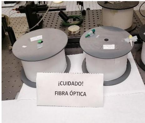
**Figura 31.** Muestras de fibra bobinas helicoidalmente.
