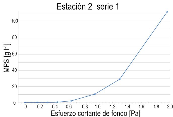
**Figura 7.** Concentración de *MPS* contra  $\tau_{bo}$  en las planicies de marea del Alto Golfo de California correspondiente a los días 20, 21 y 22 de julio del 2009. Modificada de Valencia (2009).
