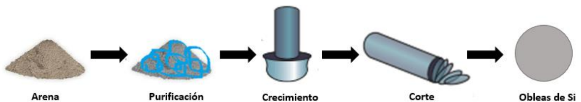
Figura 30. Representación esquemática del proceso de obtención de obleas de silicio. Imagen adaptada de (Martínez Bogado, 2011).
