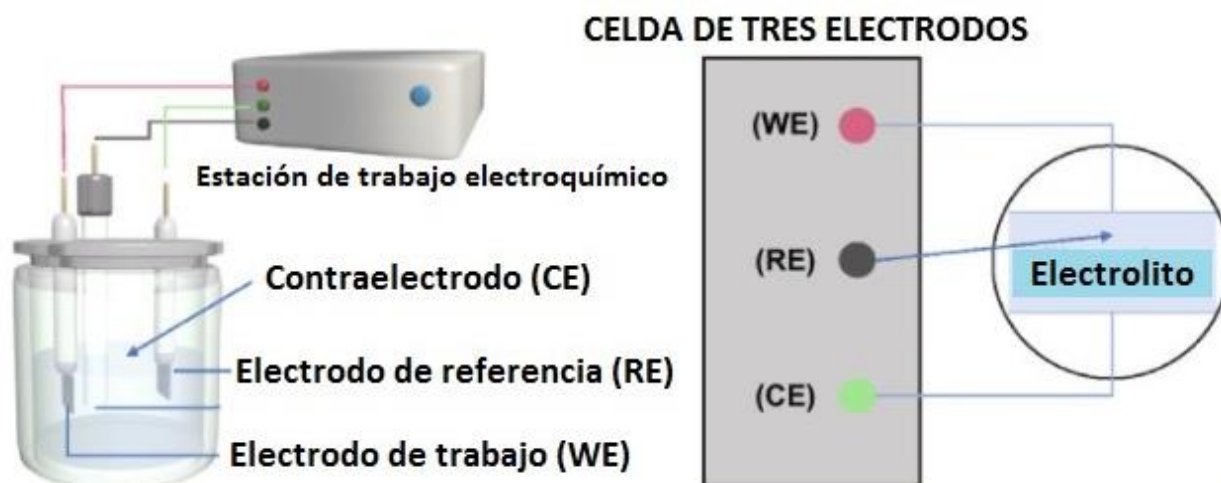
Figura 38. Representación esquemática de la configuración experimental de una celda electroquímica de tres electrodos. Imagen adaptada de (Kelly, Scully, Shoesmith, & Buchheit, 2002).
