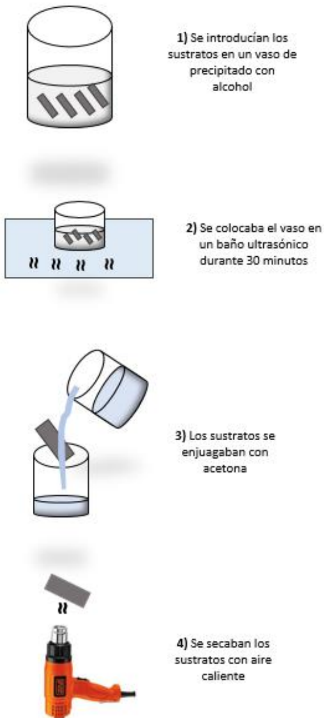
Figura 66. Representación esquemática del proceso de limpieza de los sustratos
