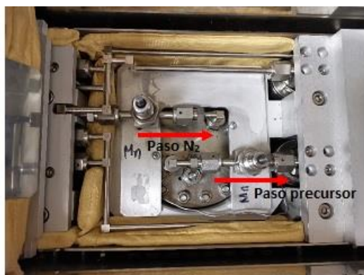
Figura 25. Contenedor metálico instalado en el equipo BENEQ TSF 200 en el área de fuentes calientes.
