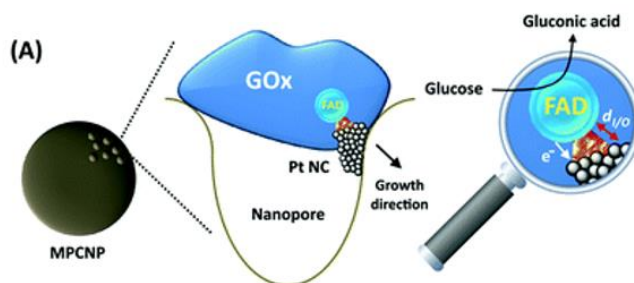
Figura 4. Formación de nanocúmulos de platino en GOx. Electrodo PtNC @ GOx / MPCNP sintetizado enzimáticamente de adentro hacia afuera (Trifonov et al., 2019).
