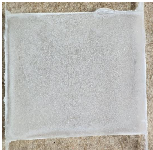
Figura 20. Depósito de \text{TiO}_2 con recubrimiento por inmersión utilizando ácido nítrico 0.1 M.
