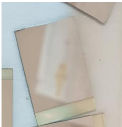
Figura 29. Película de Pt depositada por Sputtering.
