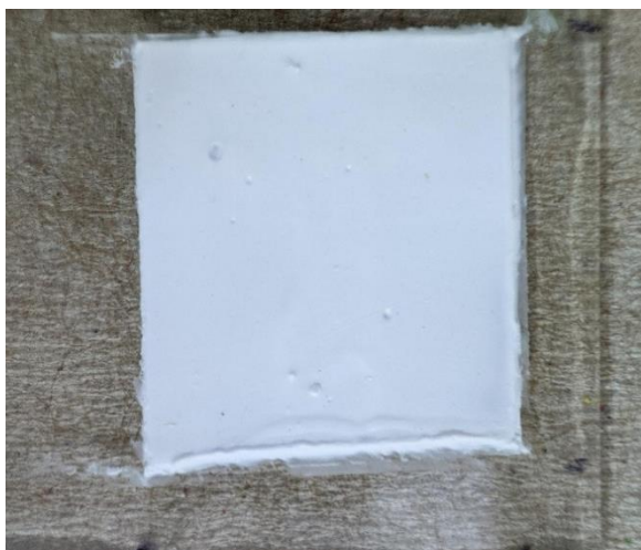
Figura 17. Superficie del \text{TiO}_2 depositado mediante Doctor Blade.
