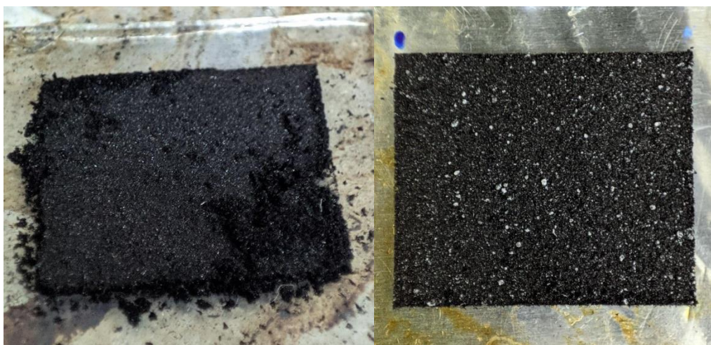
Figura 26. Contraelectrodo de carbón activado antes y después de la optimización del depósito (izquierda y derecha, respectivamente).
