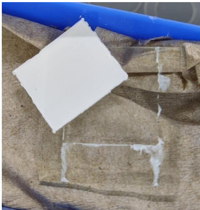
Figura 18. Depósito de \text{TiO}_2 desprendido de la superficie del vidrio ITO.
