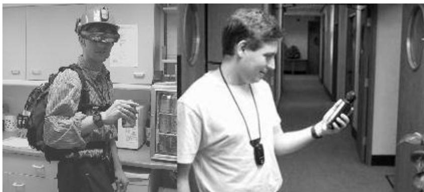
*Figura 17. De izquierda a derecha: a) Sistema de realidad aumentada con pantalla montada en la cabeza, b) Sistema de realidad aumentada en una PDA.*
