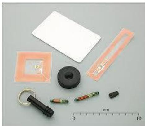
*Figura 3. Ejemplos de etiquetas, tarjeta, cápsulas y otros dispositivos RFID.*
