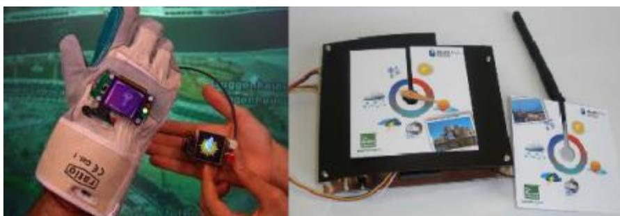
*Figura 6. Objetos aumentados con tecnología. De izquierda a derecha: a) RFIDGlove (guante con lector de RFID y mini-pantalla), b) iCompass (artefacto con RFID y una manecilla que marca el clima mediante un servicio meteorológico por Internet).*
