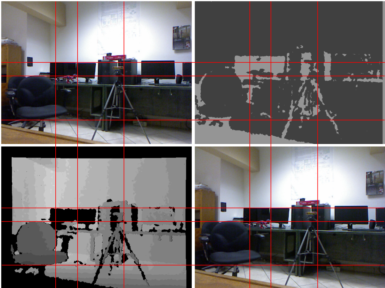
Figura 6: En la parte superior se observa la imagen de color, y la de profundidad (escala de grises) sin empatado. En la parte inferior se puede observar que la imagen de profundidad ha sido empatada con la de color, esto por medio del registro de fábrica del Kinect; de esta manera los objetos representados en color y en profundidad coinciden. Las líneas de guía muestran la alineación vertical y horizontal. Se debe notar que la imagen de profundidad empatada reduce considerablemente las sombras de la luz infrarroja (Figura 5).
