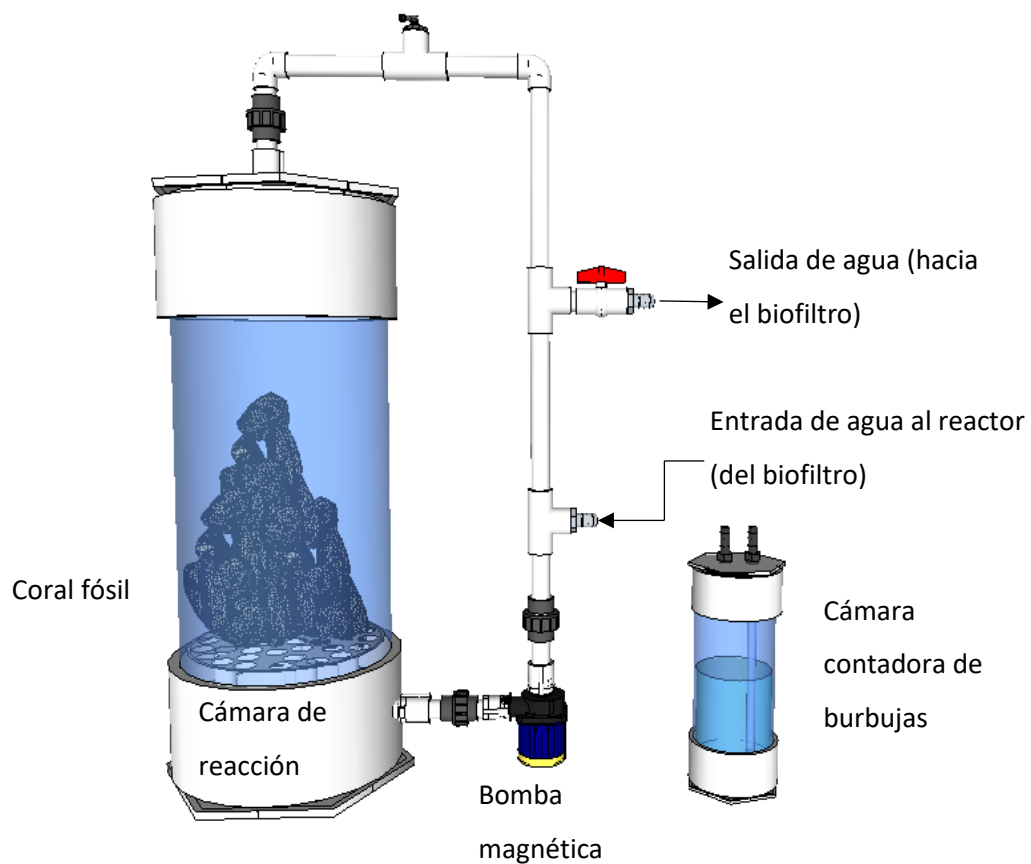
Figura 10. Reactor de calcio para el control de sistema \text{CO}_2 -carbonatos durante el pre-acondicionamiento y el acondicionamiento reproductivo del ostión japonés ( M. gigas ).
