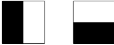
Figura 23: Filtros tipo—Haar. Izquierda, gradiente en x , derecha gradiente en y . La zona negra = 1, zona blanca = -1 . Los filtros tipo—Haar en imágenes integrales requieren solo 6 operaciones. Imagen recuperada de (Bay et al. , 2008), pág. 351.
