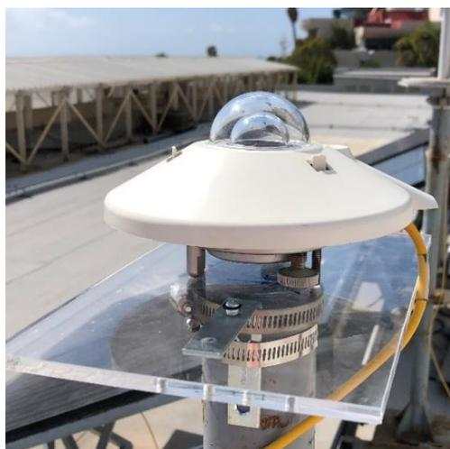
**Figura 35.** Piranómetro Kipp & Zonen modelo CMP 21.
