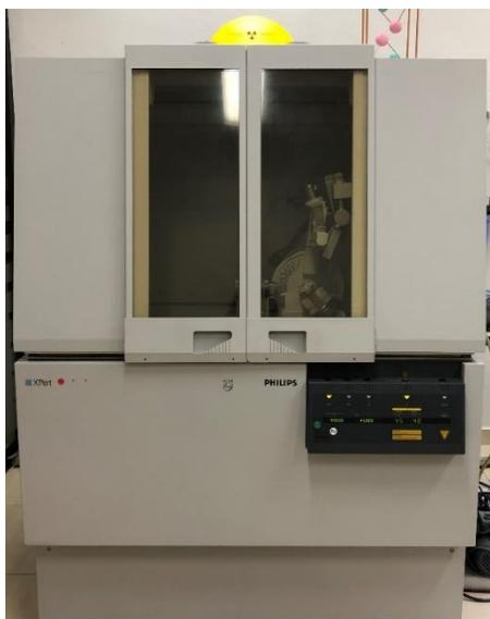
**Figura 26.** Difractómetro Philips X'pert MPD.
