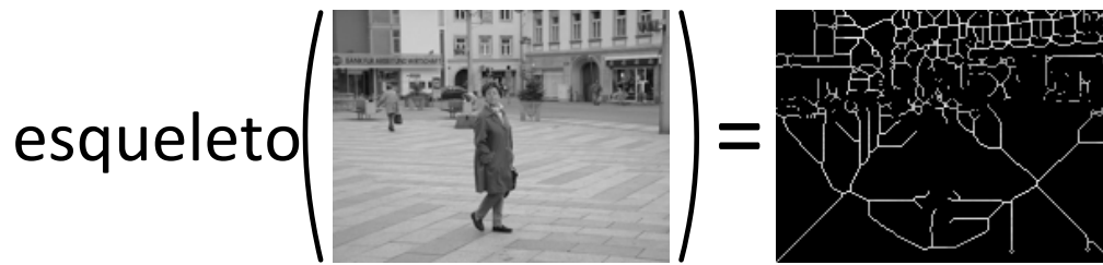
Figura 15: Ejemplo del uso de la operación morfológica de esqueleto.
