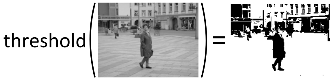
Figura 8: Ejemplo del uso de la operación de umbral de Otsu para transformar una imagen en escala de grises a una imagen binaria.
