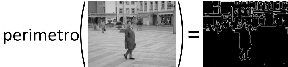
Figura 16: Ejemplo del uso de la operación morfológica de perímetro.
