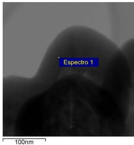
**Figura 58.** Micrografía TEM y mapas composicionales de EDXS para el borde de una esfera de AIY-50 (c).
