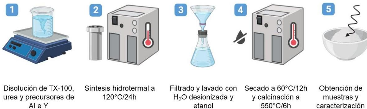
**Figura 6.** Diagrama de metodología de síntesis de los soportes AIYs (creado con BioRender.com).
