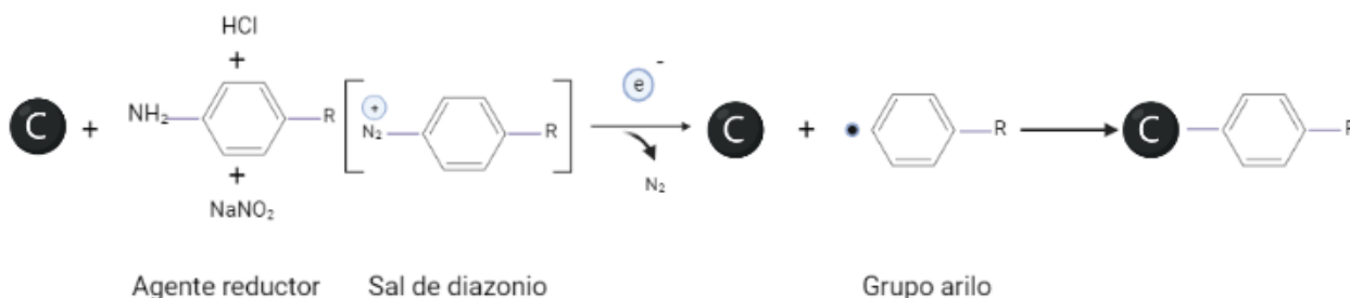
Figura 6. Funcionalización por el método de sales de diazonio (grafting) imagen adaptada de (Mahouche-Chergui et al., 2011).
