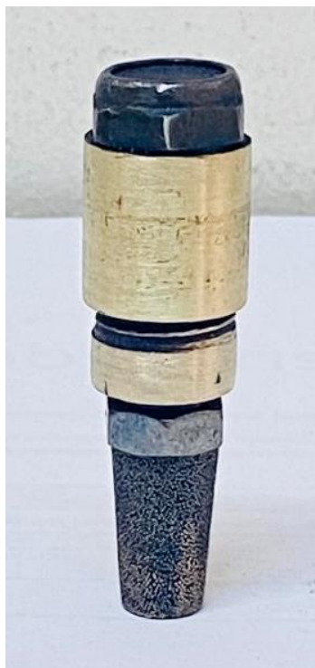
Figura 9. Cápsula metálica (adaptación para ALD polvos).
