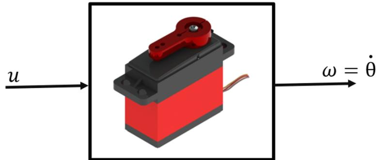
Figura 3. Diagrama de entrada-salida de un servo actuator de **velocidad**.
