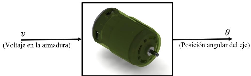
Figura 9. Bosquejo entrada-salida de un motor PMDC tipo armadura controlada.
