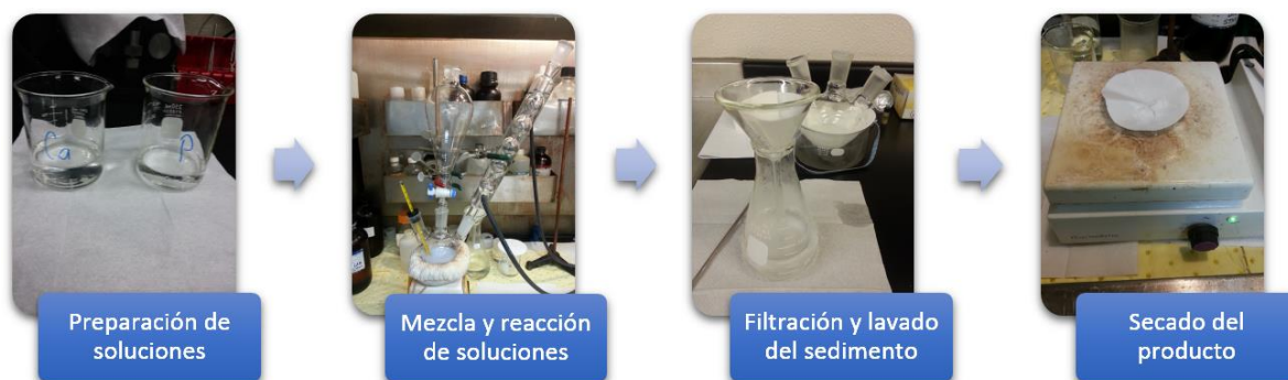
Figura 12. Diagrama del método hidrotermal utilizado para sintetizar las nanocintas de HAp.
